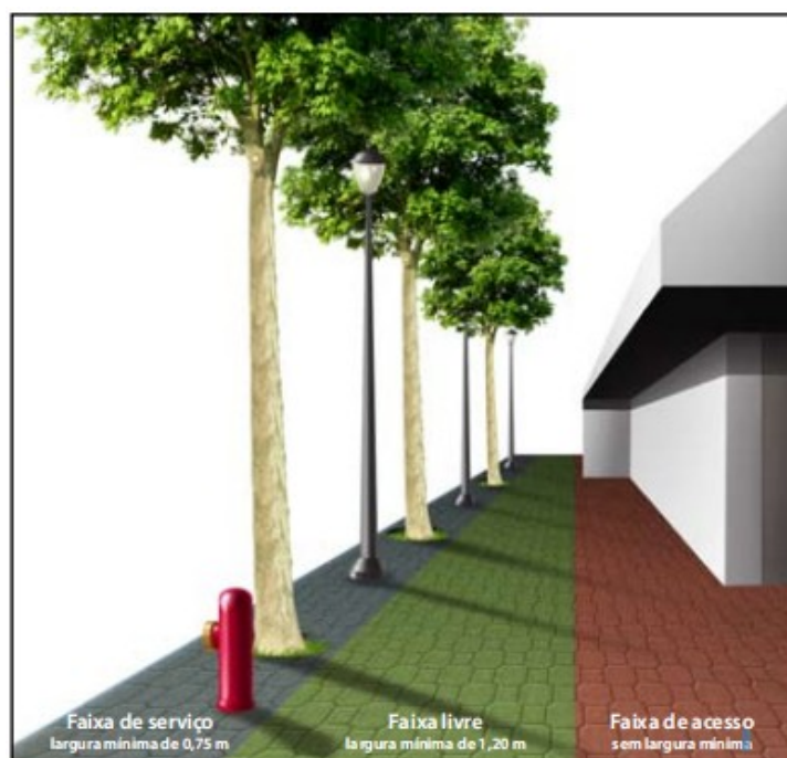
Figura 1: Esquema das faixas da calçada
